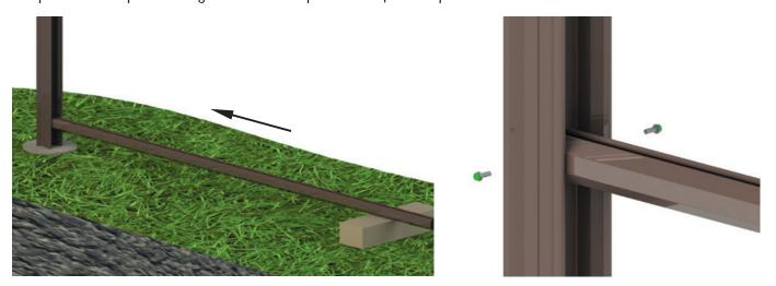
Установите второй столб, контролируя высоту по натянутой веревке. Расстояние между центрами столбов должно равняться 2504 мм.
