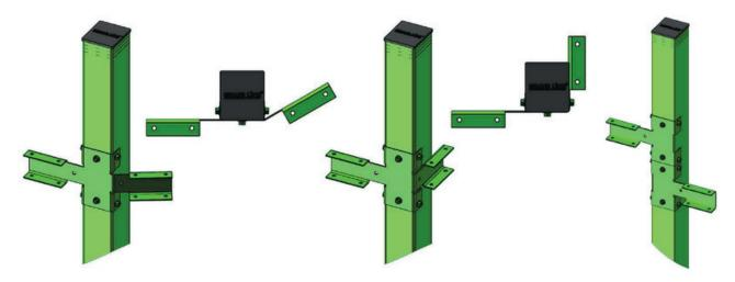
При необходимости панели можно закрепить ступенчато. Для этого на столб закрепляются дополнительные X-кронштейны. Таким образом можно нивелировать неровности грунта. Неиспользуемое ухо X-кронштейна можно отпилить.
