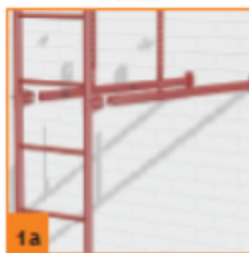
Установка подвесных кронштейнов с крепе- жем к стропилам
